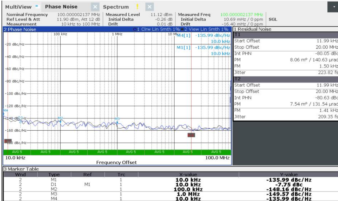
图 MBUF0101在100 MHz处 LVC MOS输出相位噪声曲线(3.3 V电源电压下)
