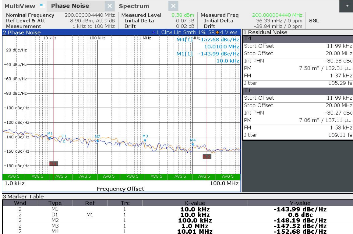
图 CMOS输出200MHz输入信号与输出信号相位噪声曲线
