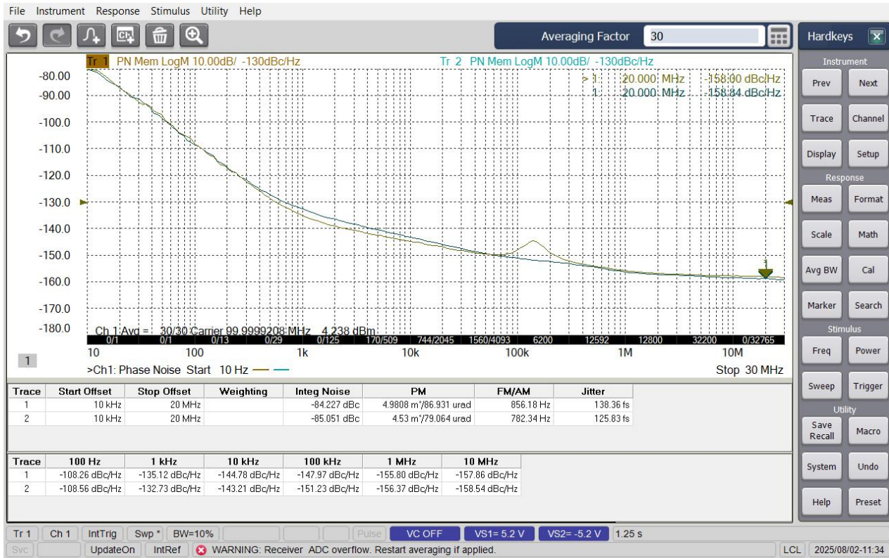
图 100MHz输出相位噪声曲线 ( V_{CC}=3.3\text{ V} )
