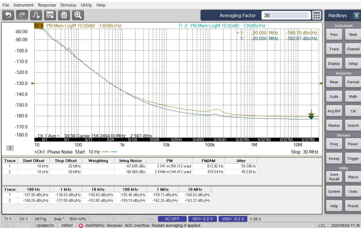
图 156.25MHz输出相位噪声曲线 ( V_{CC}=3.3\text{ V} )
