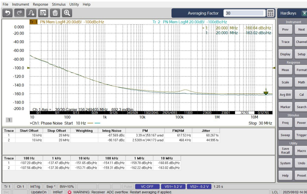
图 100MHz输出相位噪声曲线 ( V_{CC}=2.5 V )
